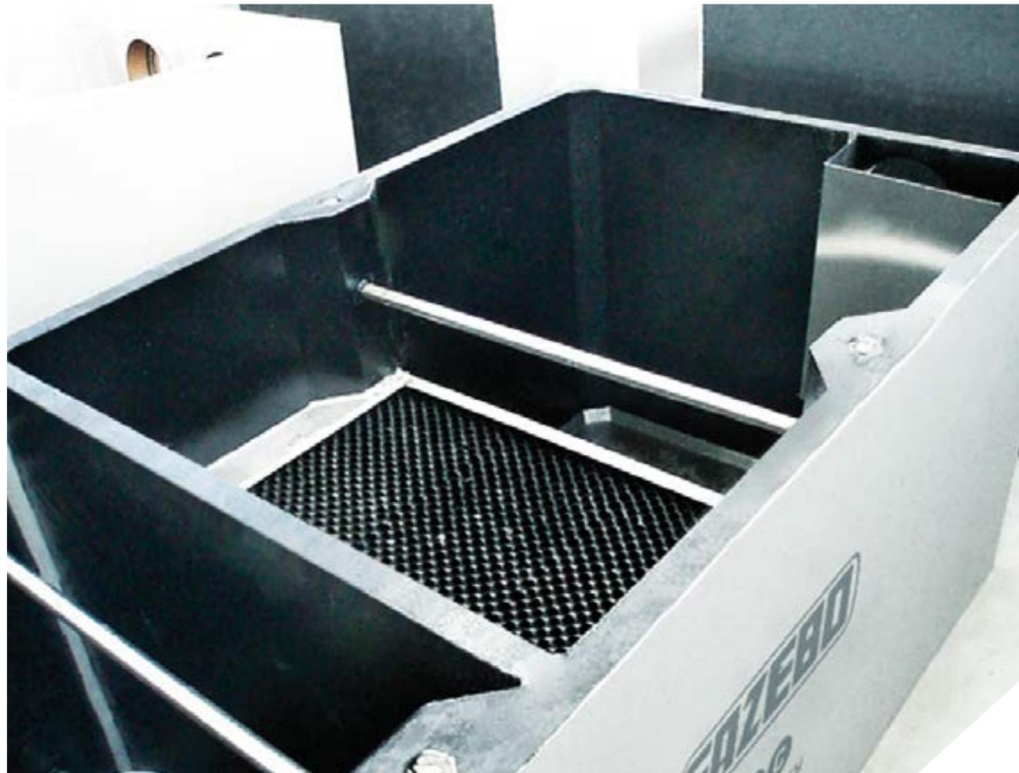
Les Déshuileurs/Décanteurs Statiques à Bloc Lamellaire permettent, par effet de gravité, d'obtenir la sédimentation et le déshuilage des particules en suspension dont le poids spécifique diffère de celui de l'eau.
