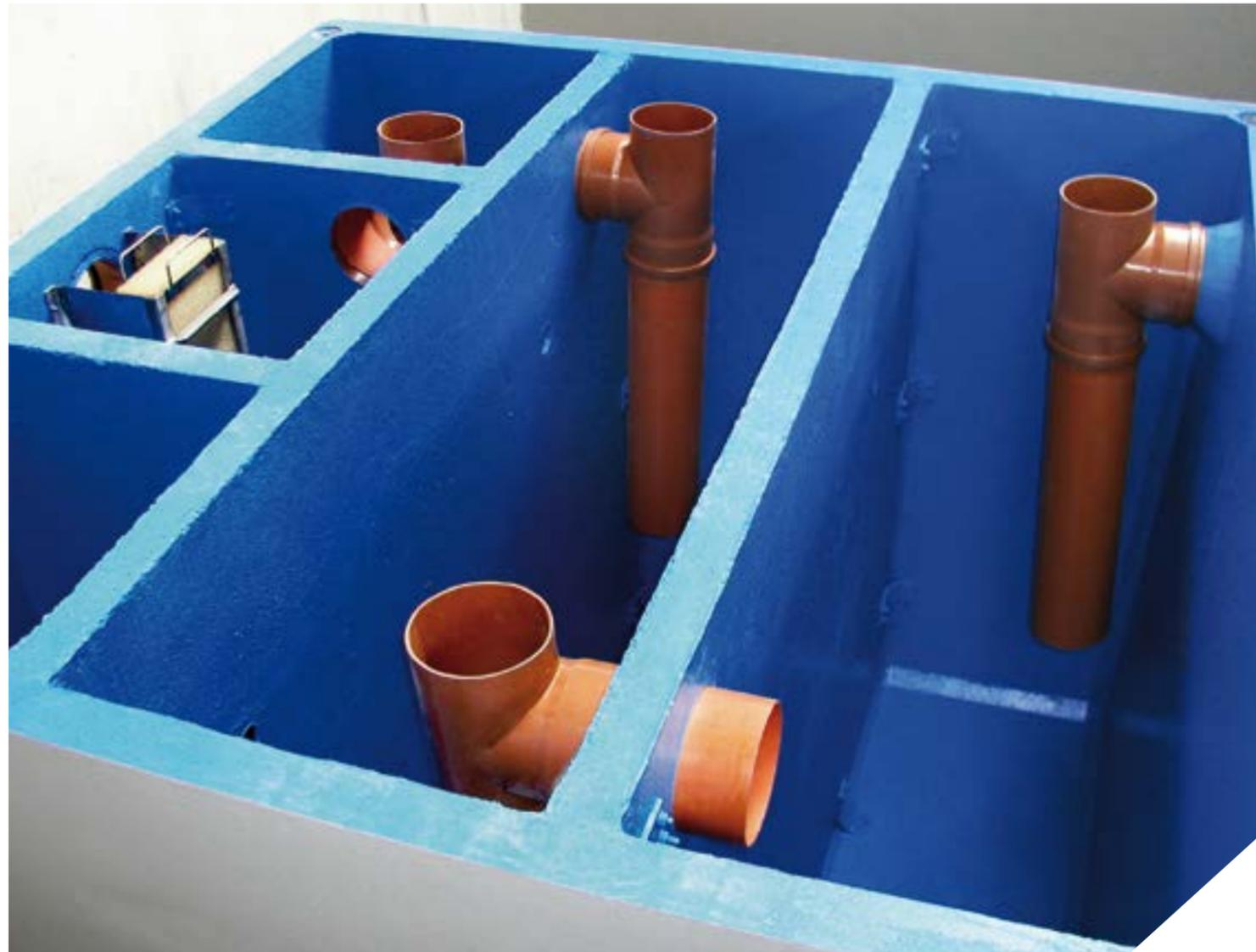
Les Déshuileurs/Décanteurs Statiques permettent, par effet de gravité, d'obtenir la sédimentation et le déshuilage des particules en suspension dont le poids spécifique diffère de celui de l'eau.
