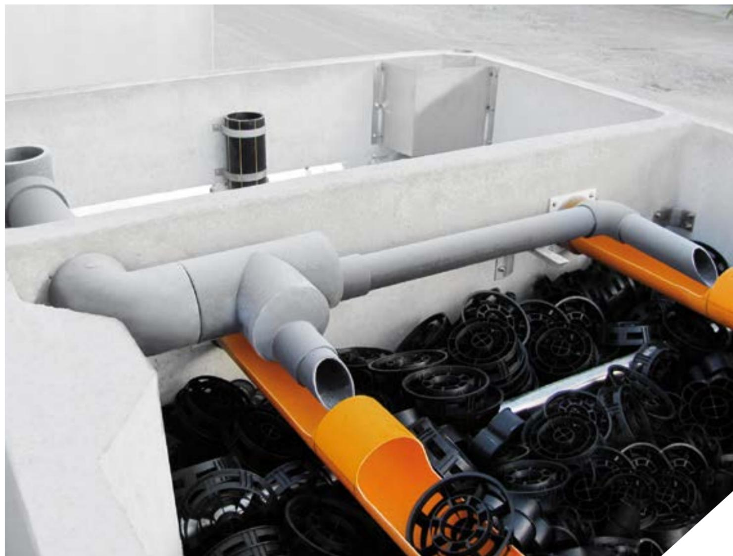
Dans l'Équipement Monobloc Gazebo, les eaux clarifiées en sortie de la Fosse Septique de type Imhoff sont traitées dans le Filtre Percolateur Aérobie, contenant des corps de remplissage en plastique (éléments circulaires à fort rapport surface/volume). Grâce à un processus impliquant des micro-organismes aérobies fixés sur ces corps de remplissage, la matière organique restante dans les effluents diminue encore plus.
