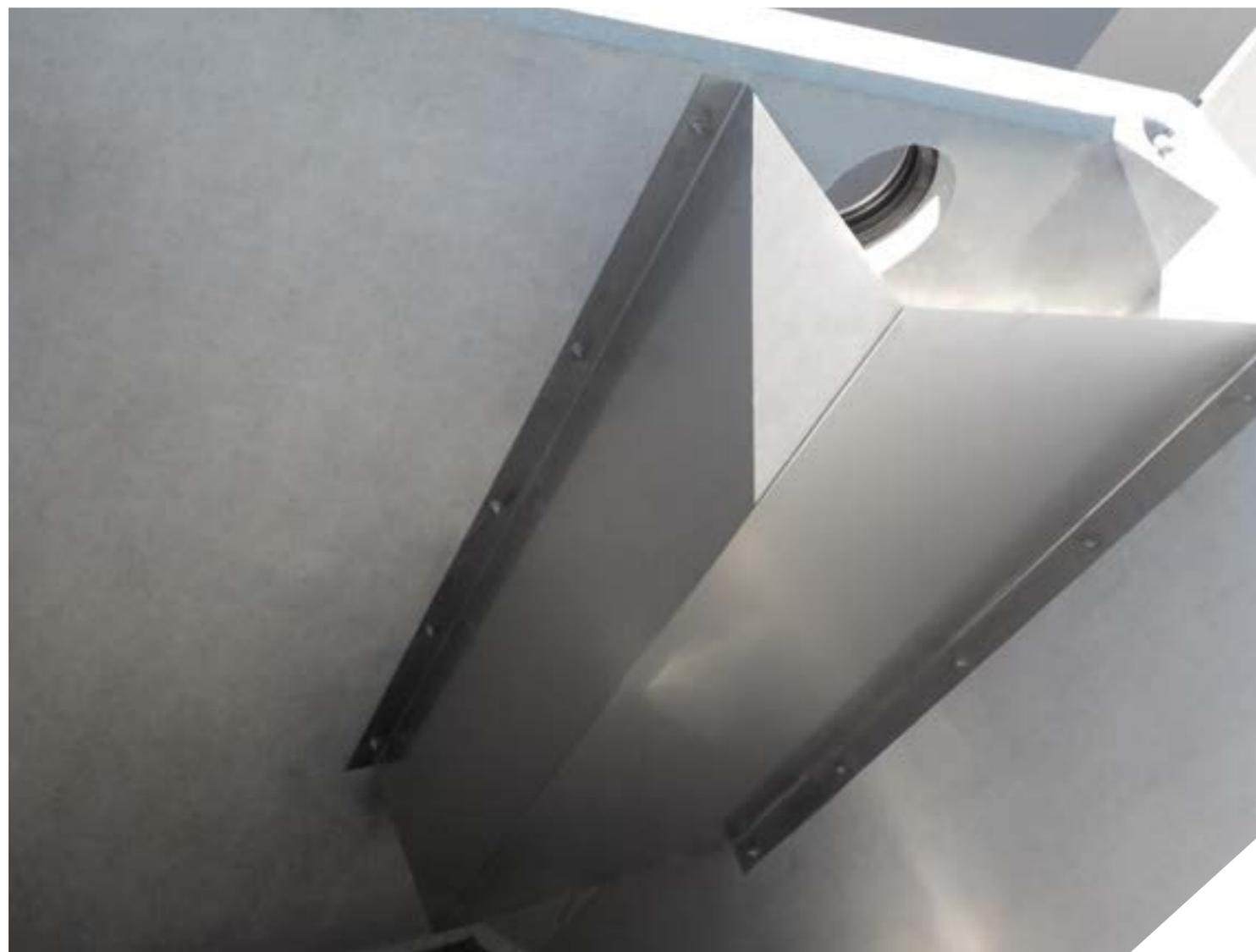
Les Dessableurs Statiques permettent, par effet de gravité, la sédimentation des particules en suspension (sables, traces de terre, etc.) dont le poids spécifique diffère de celui de l'eau, entraînant leur dépôt au fond de la cuve.
