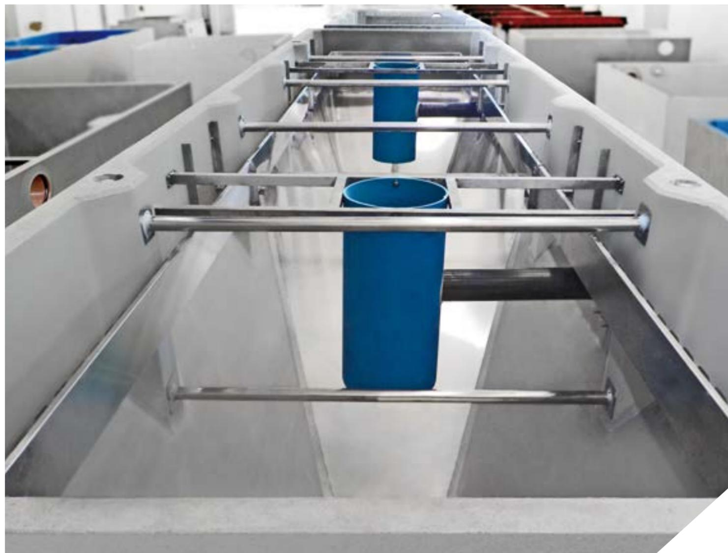
Les Décanteurs de Boues de type Dortmund, utilisés notamment pour la décantation finale des boues issues de processus de traitement biologique, chimiques et physiques, constituent un traitement physique de clarification des effluents et d'épaississement des boues.
